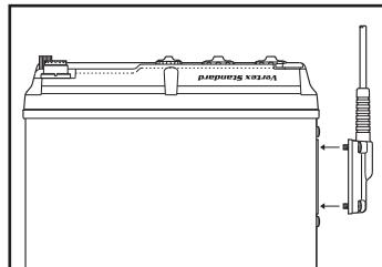
**Примечание:** В зависимости от того, как запрограммировал дилер Vertex Standard, **VX-1210** можно использовать с dipольной antennой (типа **YA-30**) или с гибкой штыревой antennой (например, **YHA-61**). За дополнительной информацией обращайтесь к дилеру Vertex Standard.
